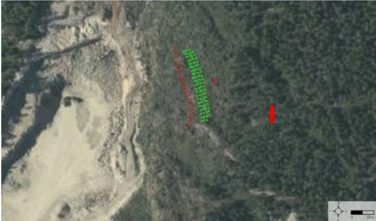
Figur 4.14: Planritning över spränghål (till vänster) för de två salvorna samt de tre enkelskotten tillsammans med filtrets läge (till höger).
