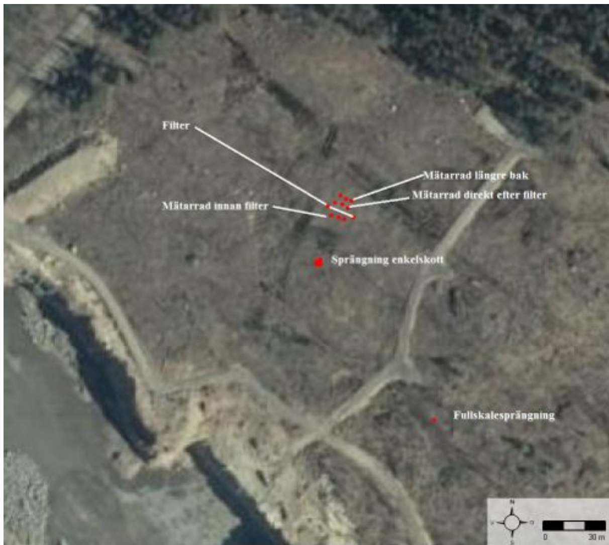
Figur 4.12: Faktiska positioner för markfilter, mätpositioner och produktionssalva vid mätningarna.
